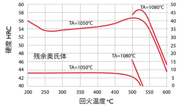
回火曲线是在对15x15x40mm大小的样品进行真空气淬热处理后获得的。
